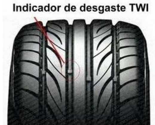
Figura 20: Figura de ubicación del indicador TWI en cauchos
