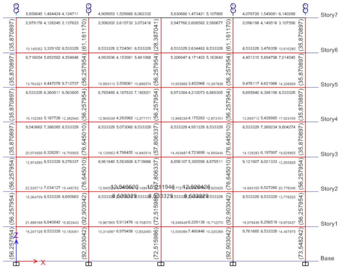
Acero de refuerzo longitudinal (Vigas y columnas) pórtico D
