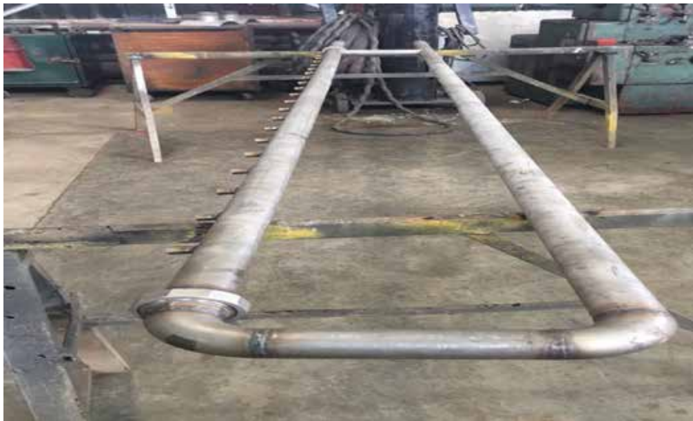
Figura 12. Boquillas de aspersion de almidón
