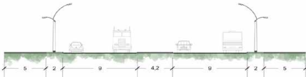
Figura 18. Perfil vial propuesto. Fuente: El Autor (2020)
