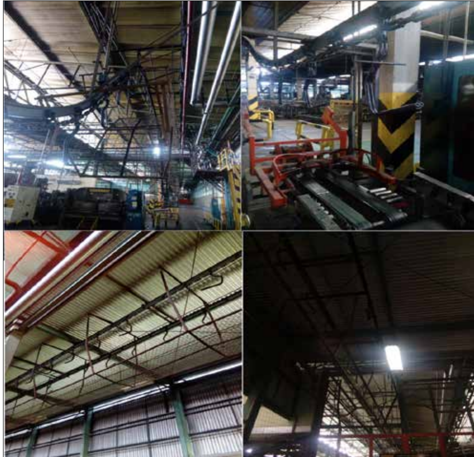
Fig. 3. – Imágenes de teleférica que transporta los cauchos
