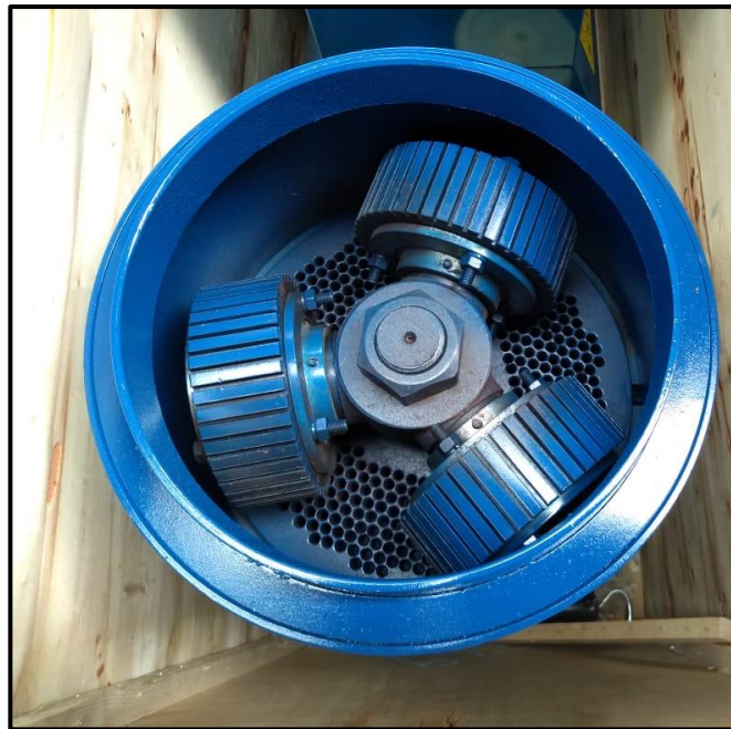
Figura 8. Matriz Plana de peletización alimentación vertical. Fuente: Gemco Energy Machinery Co., Ltd. (2020)
