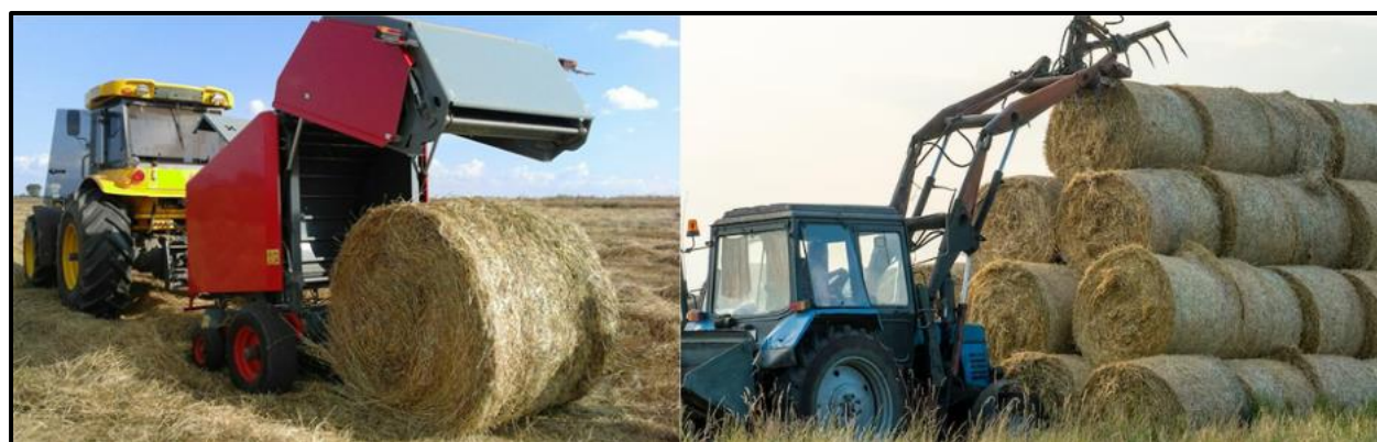
Figura 13. Tractor con manipulador hidráulico y accesorio (enrolladora) para henificación.
