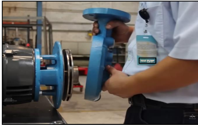
Figura 2. Desmontaje de bomba modelo KSB MONOBLOCK 25-500.
