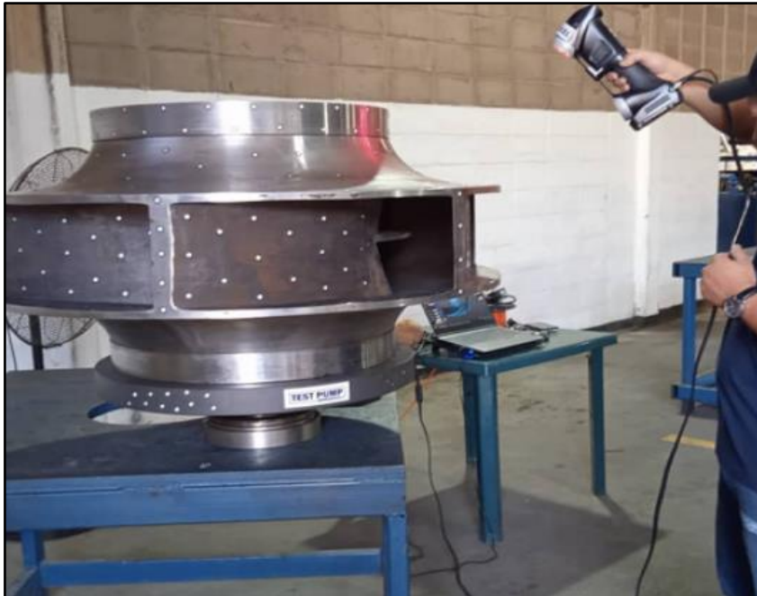
Figura 25. Escaneado de un rodete de bomba marca KSB, modelo FB 800 en los talleres de TestPump Venezuela C.A.
