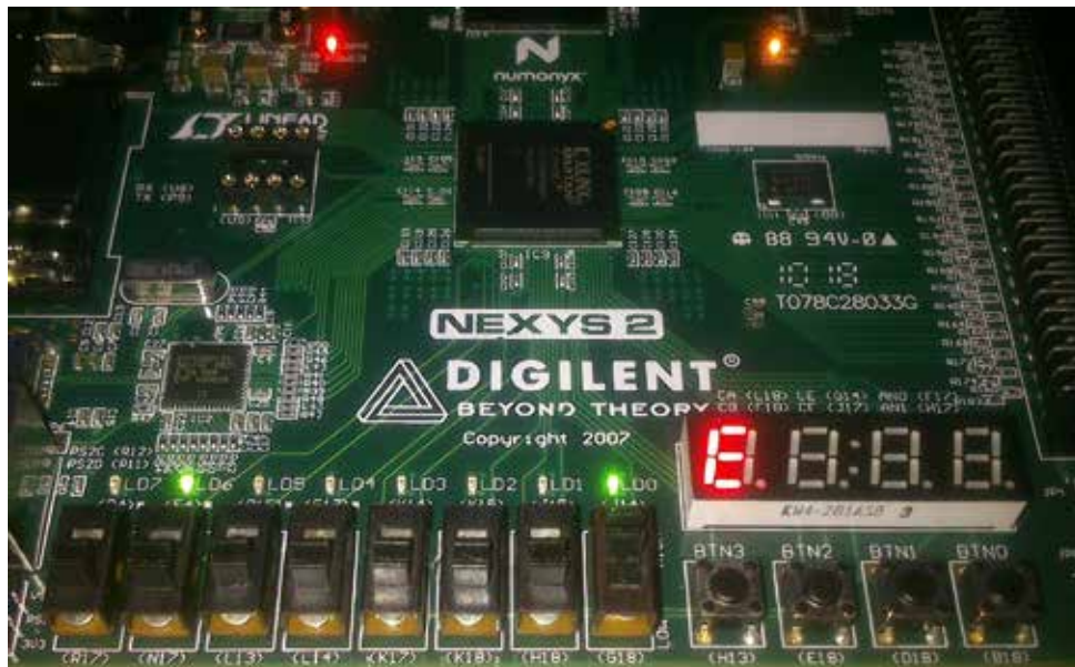
Figura 24: Funcionamiento del Verificador de Paridad SW0 Activo. Fuente: Los Autores.
