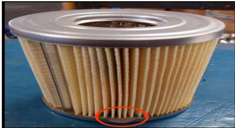
Figura 12: Mal apariencia del elemento filtrante. Fuente: Farfan. P.
