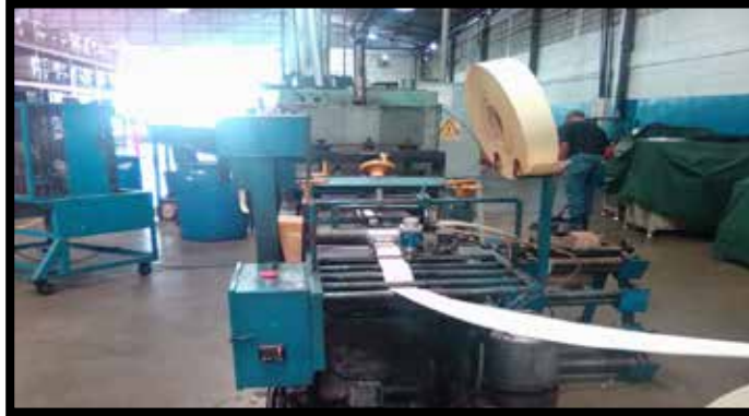
Figura 1: Plisadora del papel filtrante Fuente: Departamento de Ingeniería Mann+Hummel.
