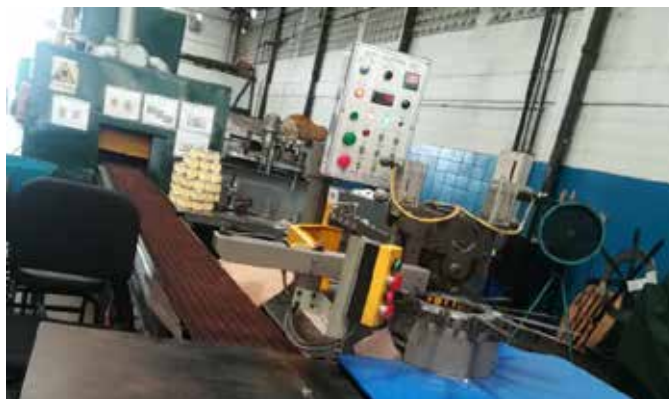
Figura 13: Cadena transportadora oxidada. Fuente: Farfan. P.
