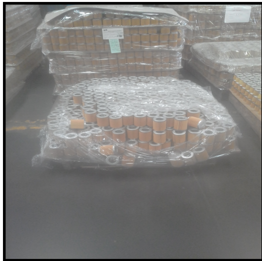
Elementos filtrantes caídos, mal envueltos.
