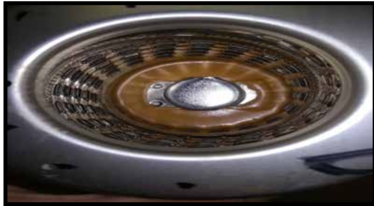
Figura 11: Exceso de resina en la tapa elemento inferior. Fuente: Farfan. P.
