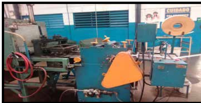
Figura 2: Plisadora del papel filtrante Fuente: Departamento de Ingeniería Mann+Hummel.
