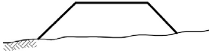
Figura 5: Sección en Relleno o Terraplén.
