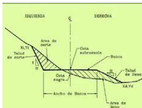
Figura 3: Elementos para el Cálculo de áreas y chaflanes.
