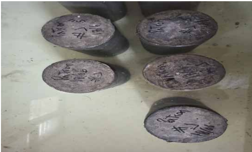
Figura 31. Desencofrado e identificación de cilindros de la muestra patrón.
