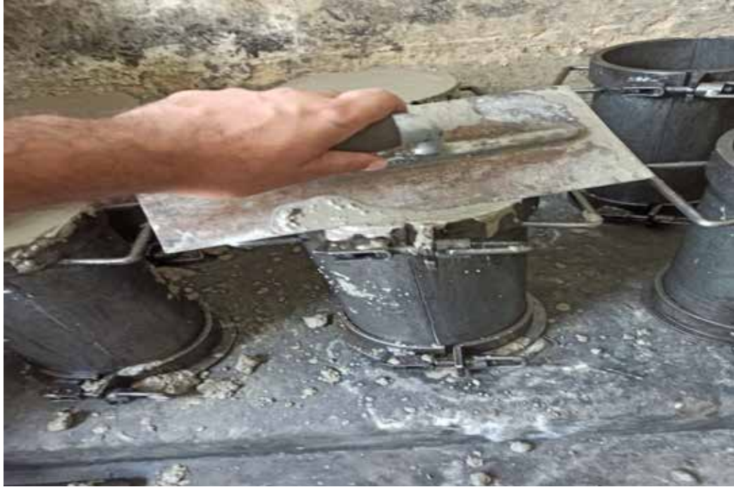
Figura 30. Enrasado de cilindros.
