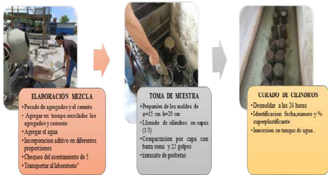
Figura 22. Esquematzación del proceso de elaboración, toma de muestra y curado de cilindros.
