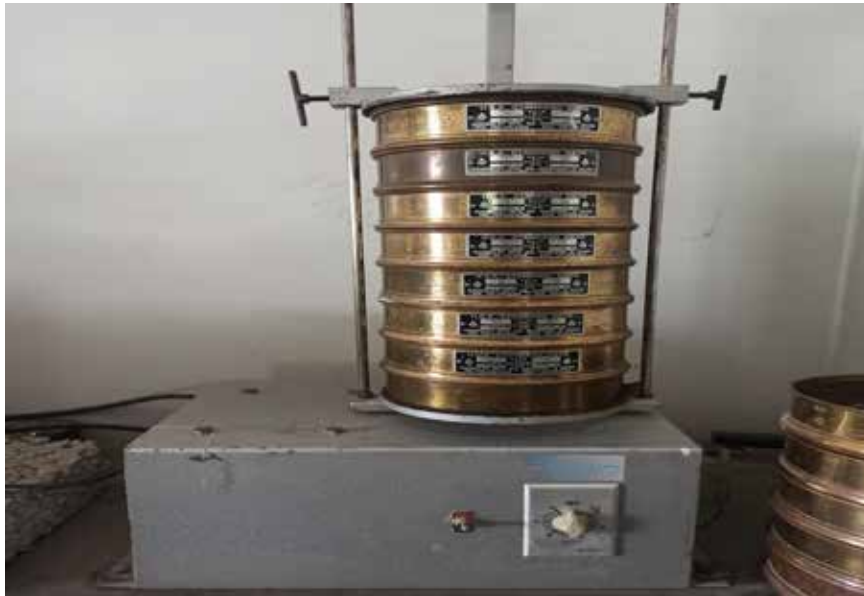
Figura 15. Tamizado de agregados fino y grueso.
