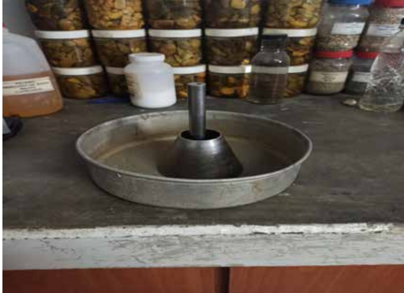
Figura 18. Molde cónico para observación de la muestra visual de superficie seca.
