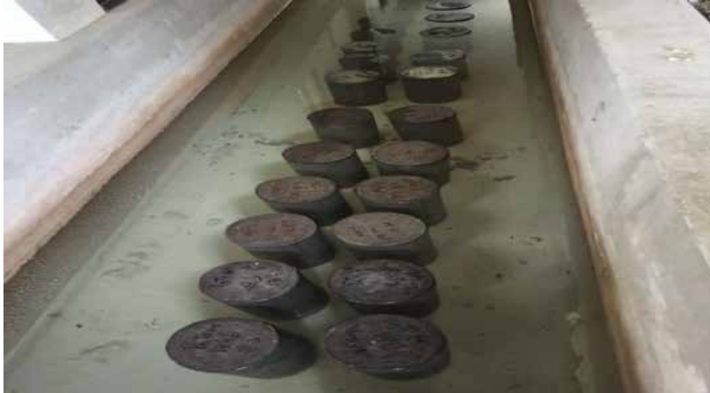
Figura 34. Curado de cilindros pruebas.
