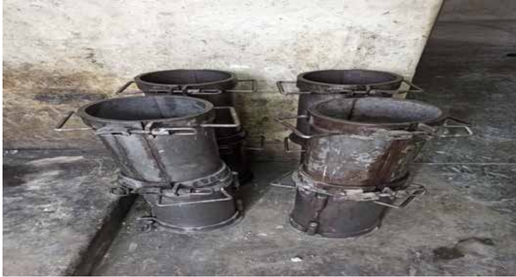
Figura 28. Preparación de moldes de los cilindros.
