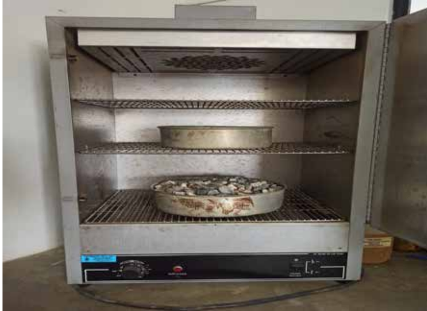
Figura 16. Secado de la muestra en horno.
