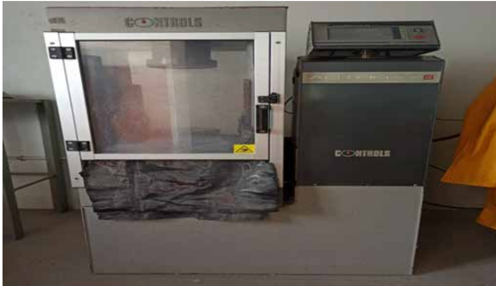
Figura 36. Prensa para la realización del Ensayo de compresión del concreto.
