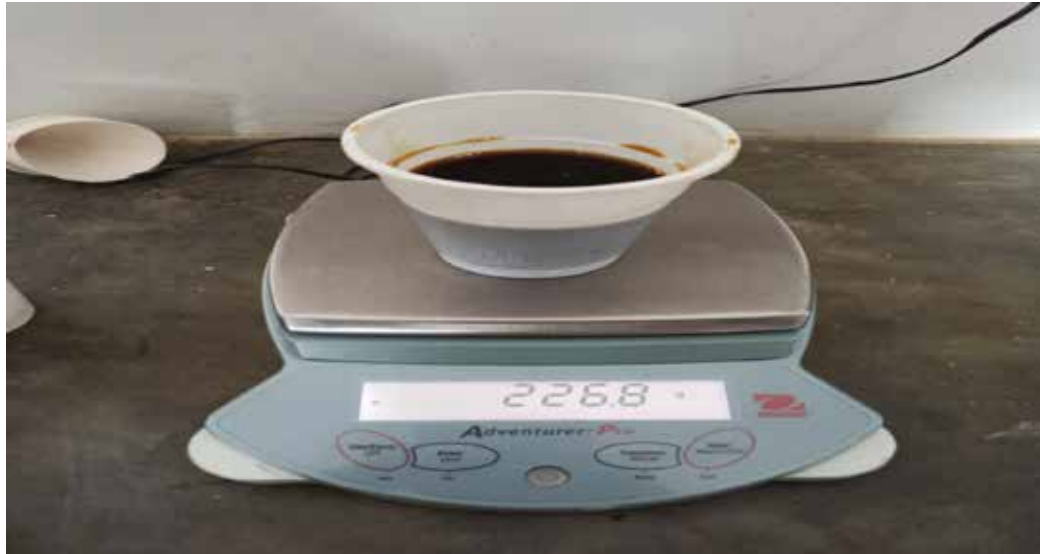
Figura 24. Pesado del aditivo para la mezcla.
