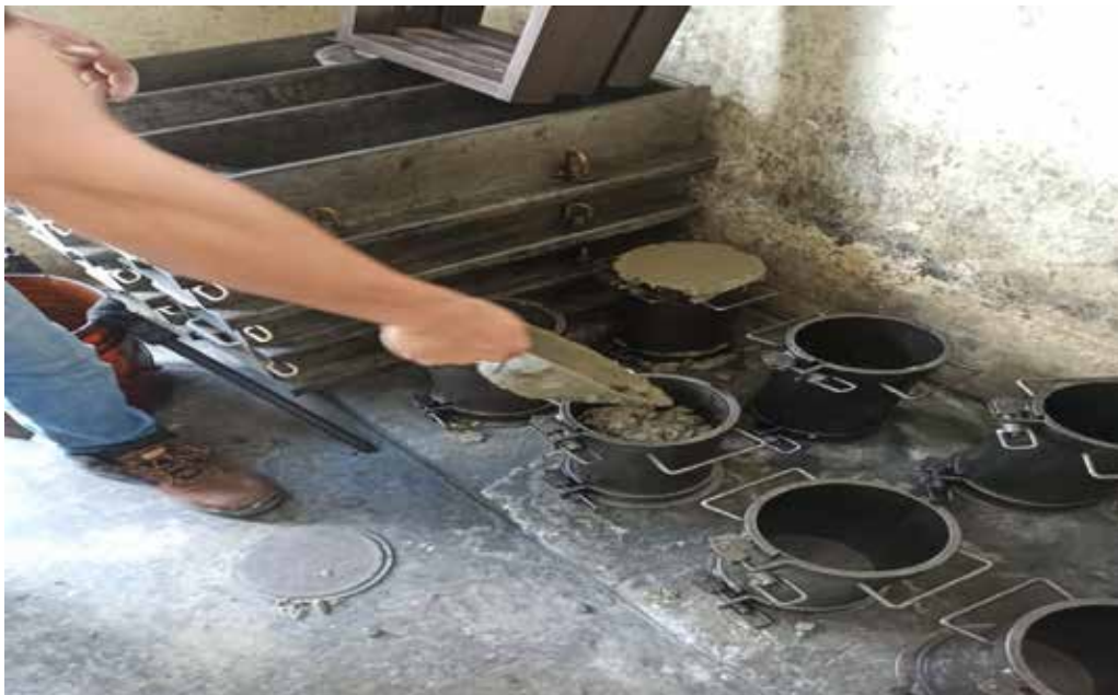
Figura 29. Toma de cilindros para diferentes dosificaciones de aditivo.
