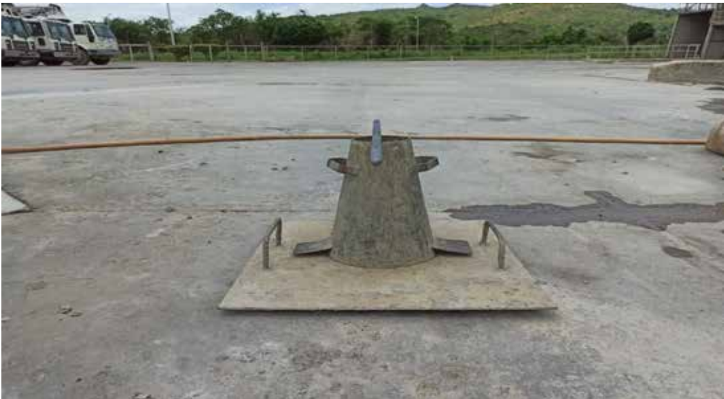
Figura 27. Comprobación del asentamiento de la mezcla Cono de Abrams de 5”.
