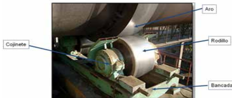
Figura 29 Rodillos de soporte
