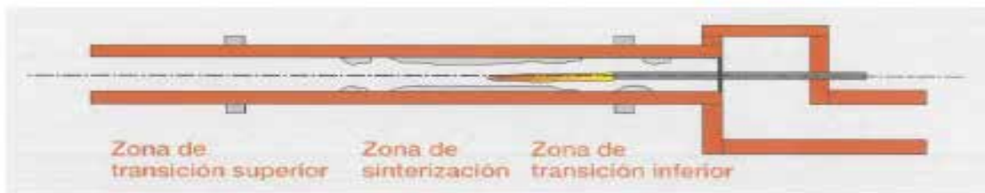
Figura 40 Zonas de afectación de refractarios Fuente Orduz (2012)
