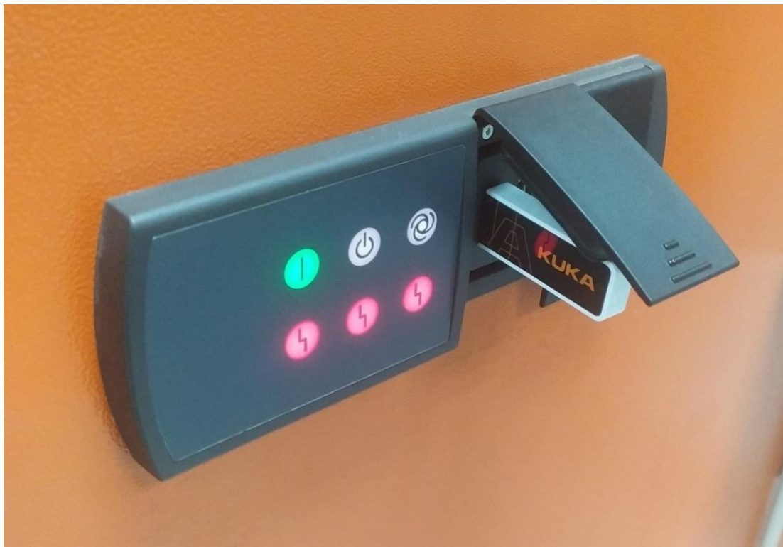
Figura 39: Leds de la CCU indicando la finalización del restablecimiento de imagen.
