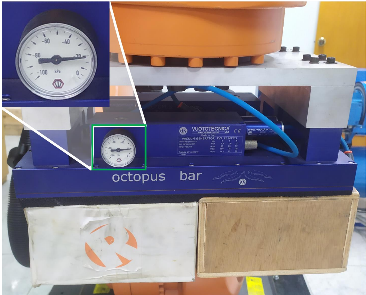
Figura 81: Segunda prueba realizada al sistema OCTOPUS con dos cajas, una de madera y otra de madera y papel, para un peso total de tres kilos.
