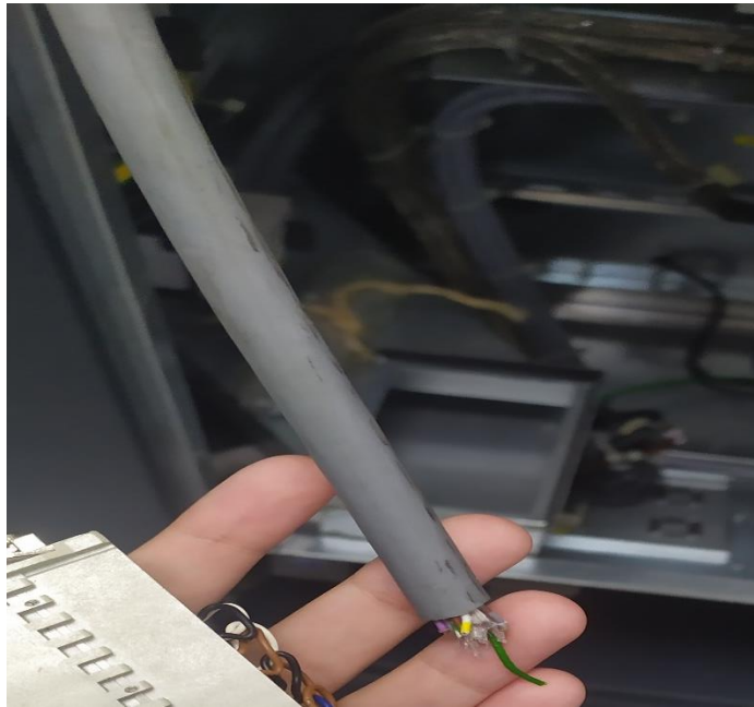
Figura 9: Desconexión del cable de señales de control de las herramientas terminales del robot KUKA KR180.
