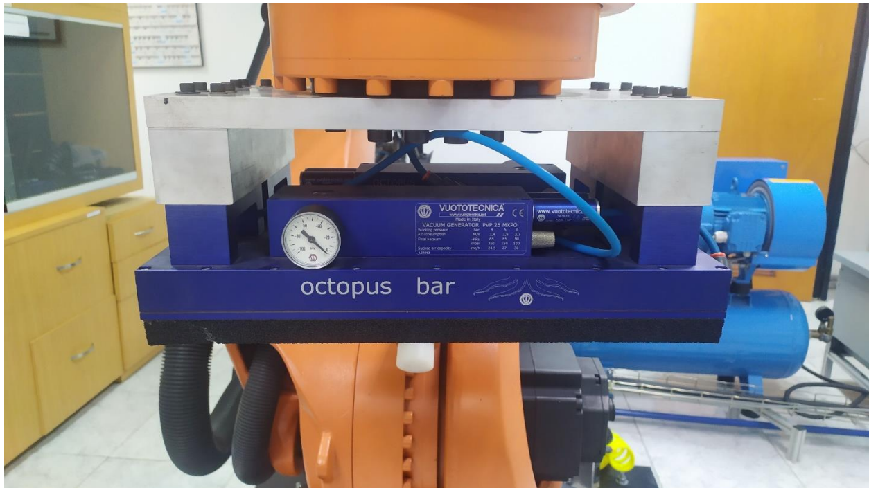
Figura 78: Sistema de agarre por vacío para paletizado de Vuototecnica presente en la celda de trabajo de la empresa Neumática R. Fuente: Alenza, M. (2023).
