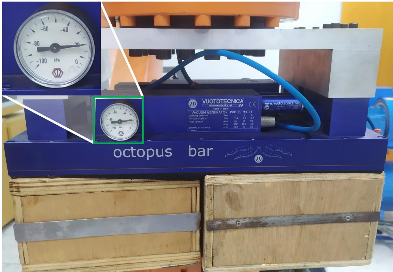
Figura 80: Primera prueba realizada al sistema OCTOPUS con dos cajas de madera para un peso total de dos kilos.
