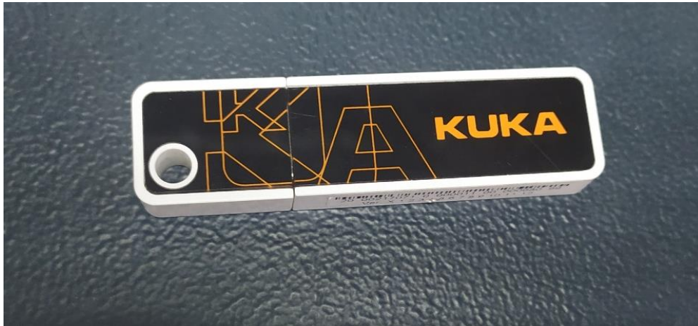
Figura 35: KUKA Recovery USB Stick. Unidad de memoria USB para restablecimiento del sistema de la unidad de control KRC4 del robot KUKA.
