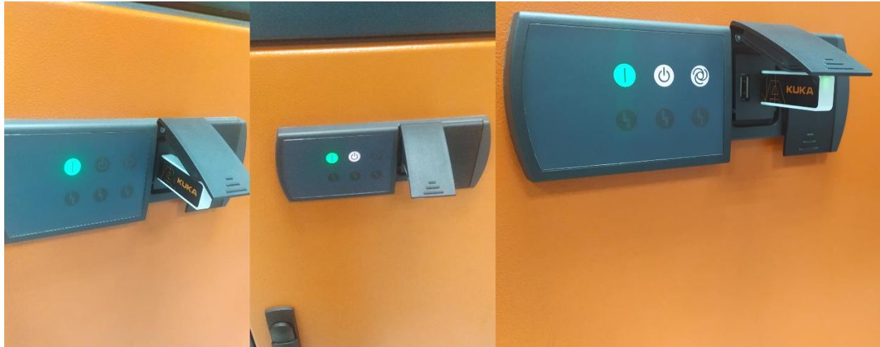
Figura 38: Secuencia de encendido de leds indicadores en la KRC4 de la celda robotizada.
