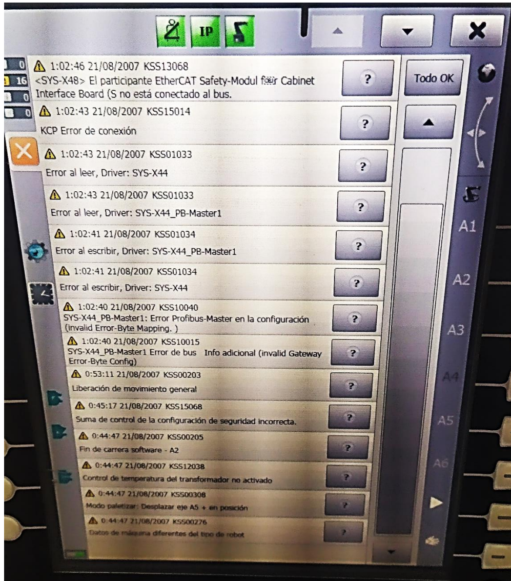
Figura 40: Lista de errores de software indicada luego del restablecimiento de imagen de la unidad de control KRC4. Fuente: Alenza, M. (2023).
