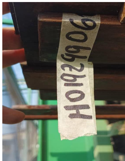
Figura 15. Identificación de activos con material incorrecto
