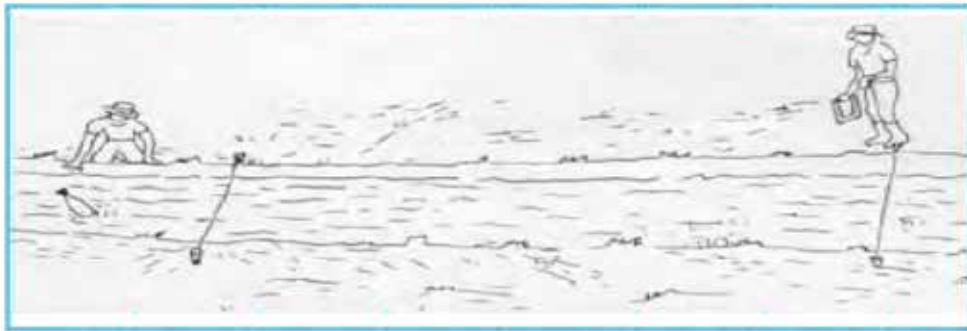
Figura 6. Lanza del flotador a 3 metros antes del punto A.
