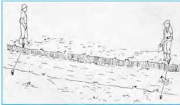
Figura 8. El flotador pasa por segunda medida, se termina de tomar el tiempo.
