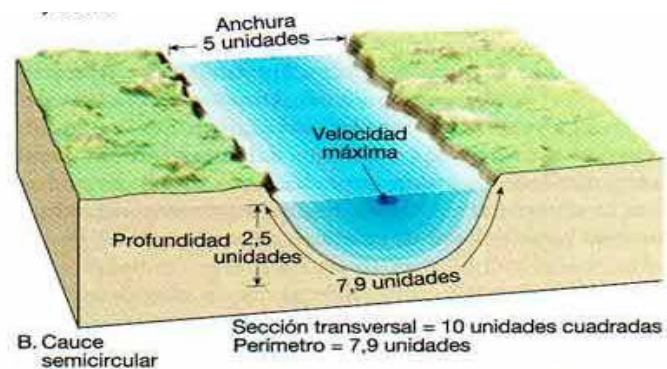
Figura 1. Influencia de la forma del cauce sobre la velocidad.
