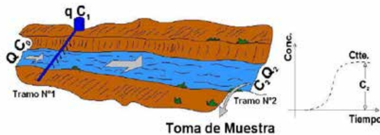
Figura 14. Medición de caudales por medio de trazadores (Método de inyección continua).
