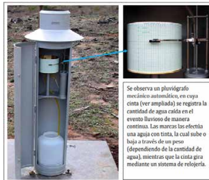
Figura 25. Pluviógrafo y cinta de registro.
