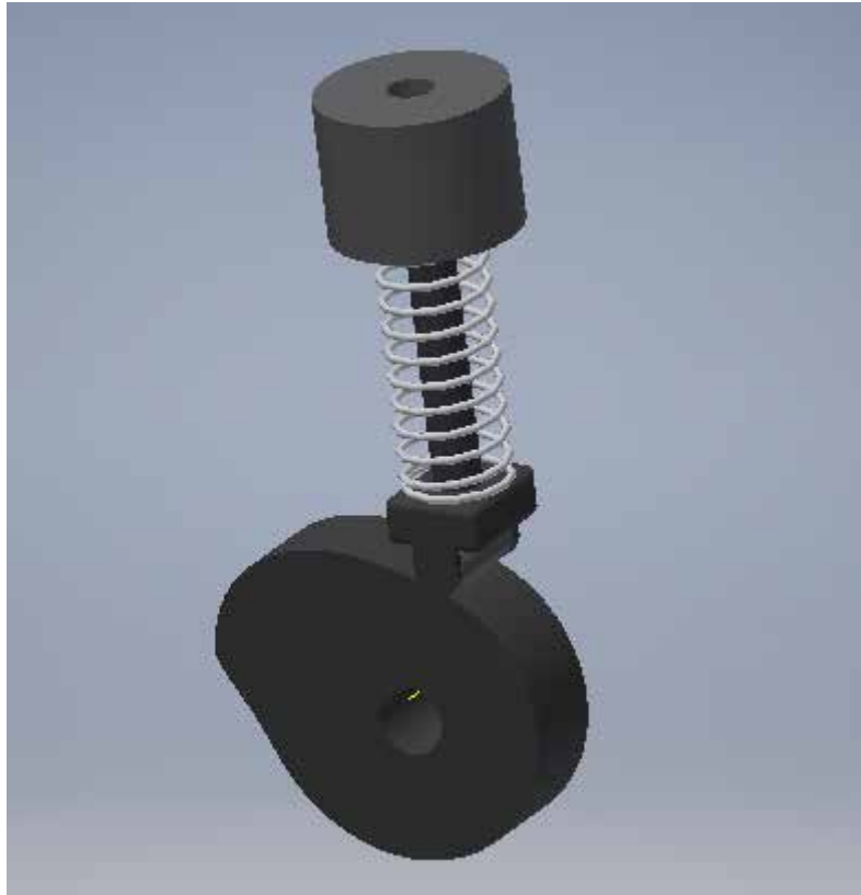
Figura 34: Mecanismo leva seguidor tras ser ensamblado Fuente: Barrios E. y Mendez C. (2019).
