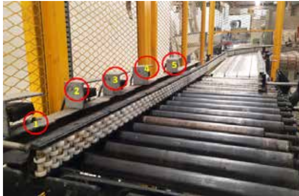
Figura 14. Transportador entrada al robot “Sensores detectores de Cajas”
