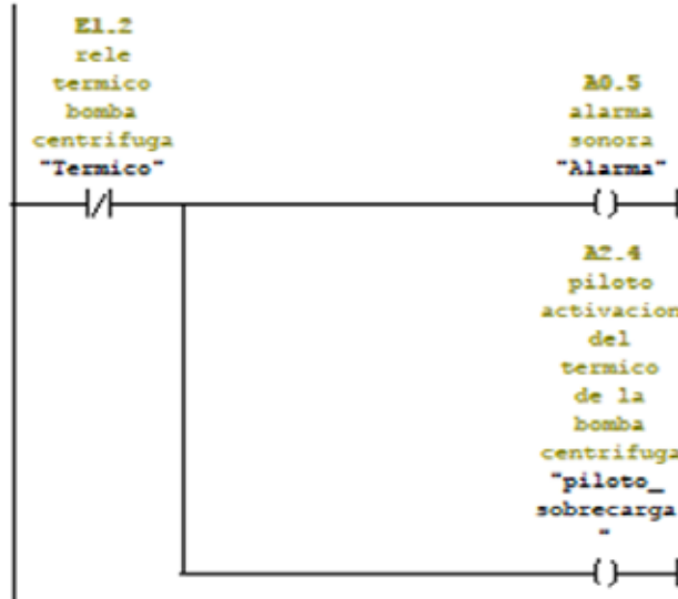
Figura N°40 alarma relé motor de la bomba.
