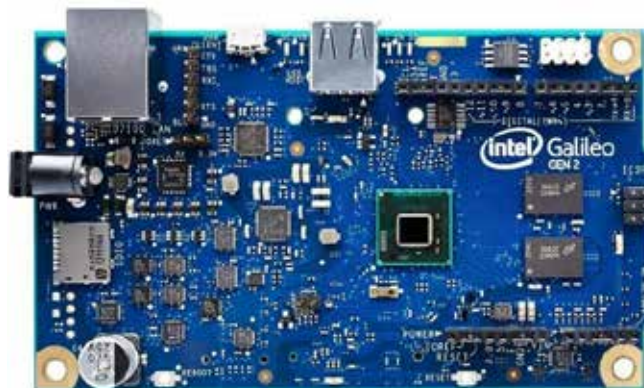
Figura 57. Galileo Gen 2 de Intel.
