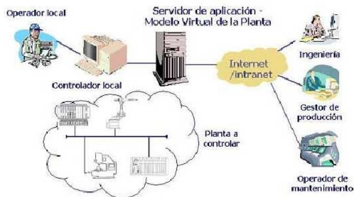
Figura 12. Ilustración Red industrial Ethernet.
