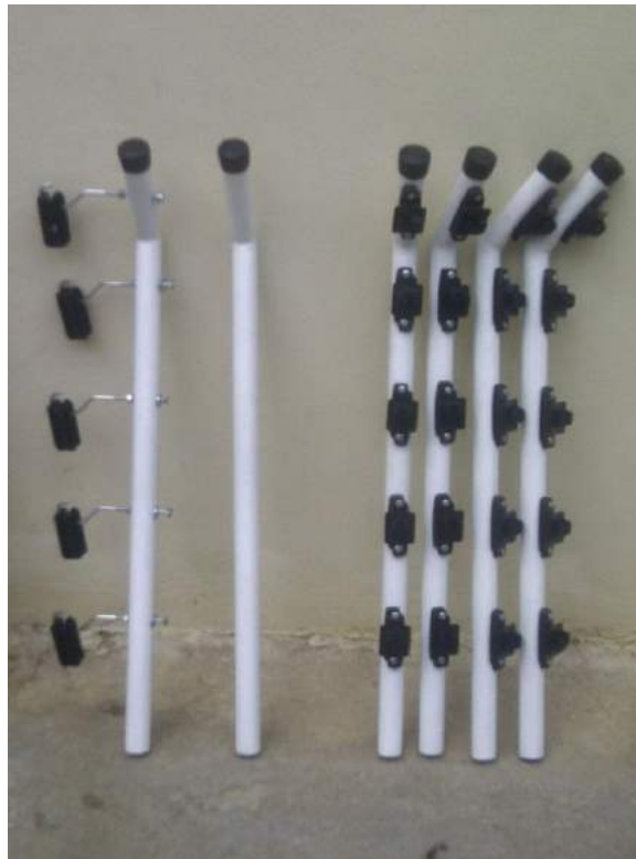
Figura Nro. 7 Tuberías cerco eléctrico
