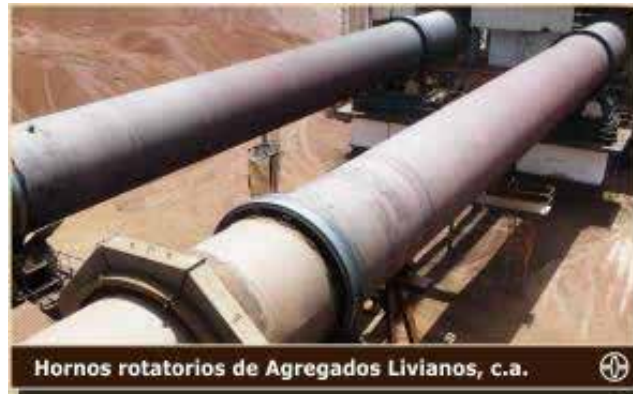
Figura 1. Hornos rotatorios de Agregados Livianos.
