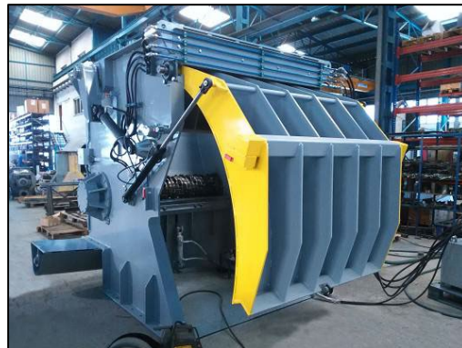
Figura 5: Molino desgarrador Fuente: Interempresas (2021)
