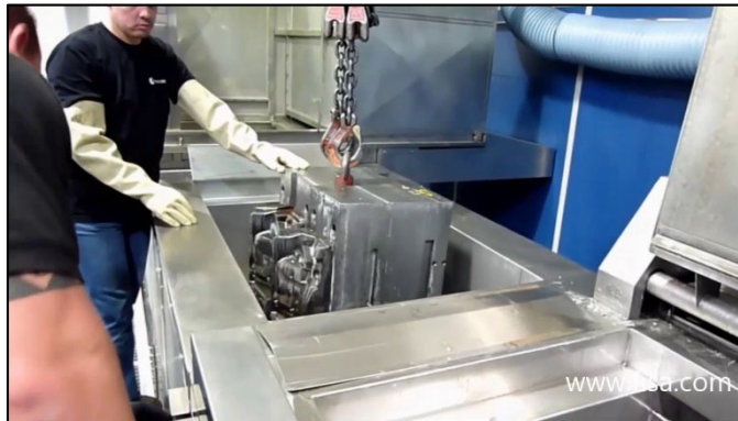
Figura 21: Limpieza de moldes por Ultrasonido
