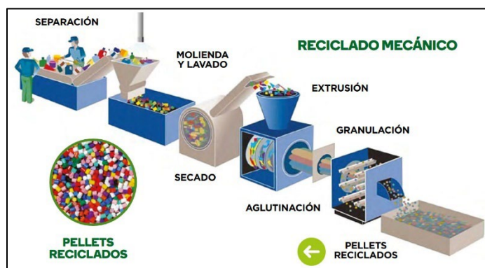
Figura 17: Reciclado mecánico de plásticos
