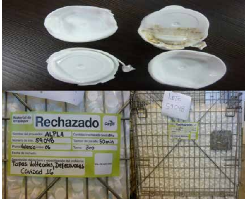
Tapas Brolio, volteadas y defectuosas. Proveedor: ALPLA
