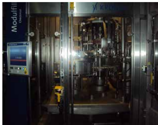
Llenadora, llenado de la botella con el aceite y tapadora.
