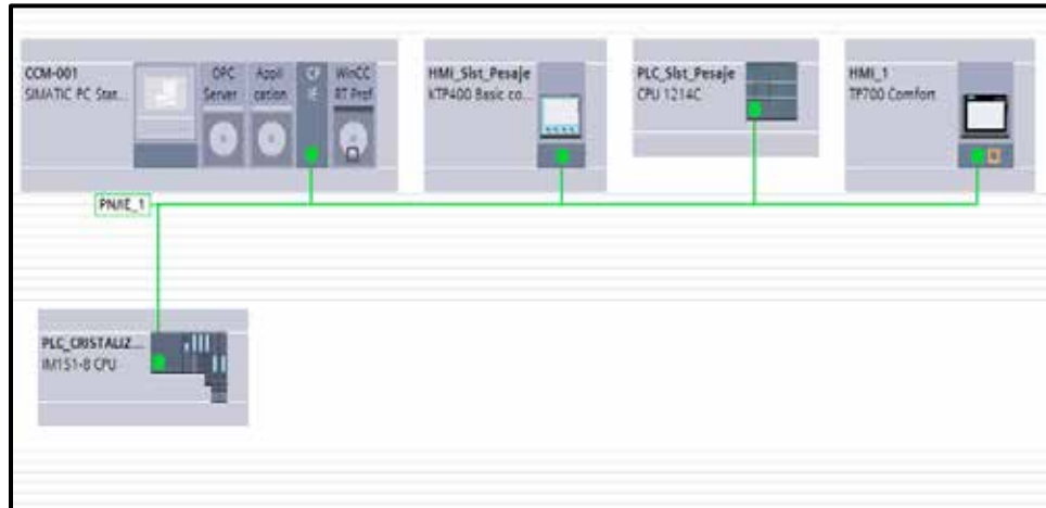
Figura 22 Configuración actual de la subred de Fraccionamiento y el Sistema de pesaje.
