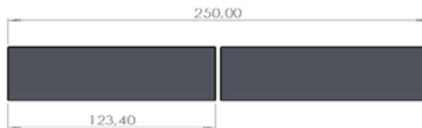
Figura 17. Vista superior de la probeta de doblado utilizando SolidWorks.
