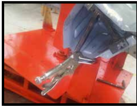
Figura 47: Propuesta de plantilla correctiva para realizar agujeros de los soportes “seal”.
