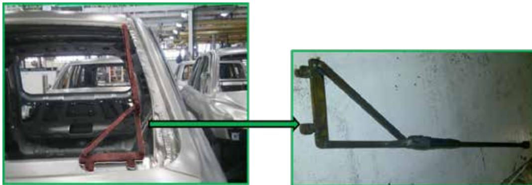
Figura 46: Propuesta de diseño de una plantilla de verificación de orificios en la estación 15 de Tapicería.
