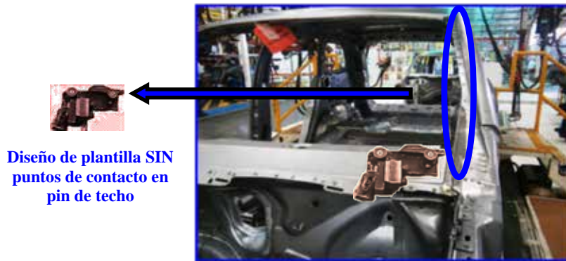
Figura 20: Plantilla sin puntos de contacto en pin de techo. Fuente: Departamento de Manufactura de FCA Venezuela (2018).
