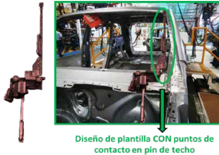
Figura 45: Propuesta de mejora de la plantilla de perforación de orificios en la estación 15 de Tapicería.
