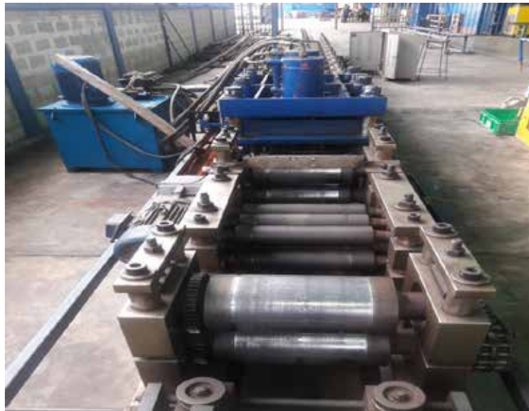
Figura 3: Planta Rubik Assembly C.A. Línea de producción de columnas para bastidores (Roll Forming)
