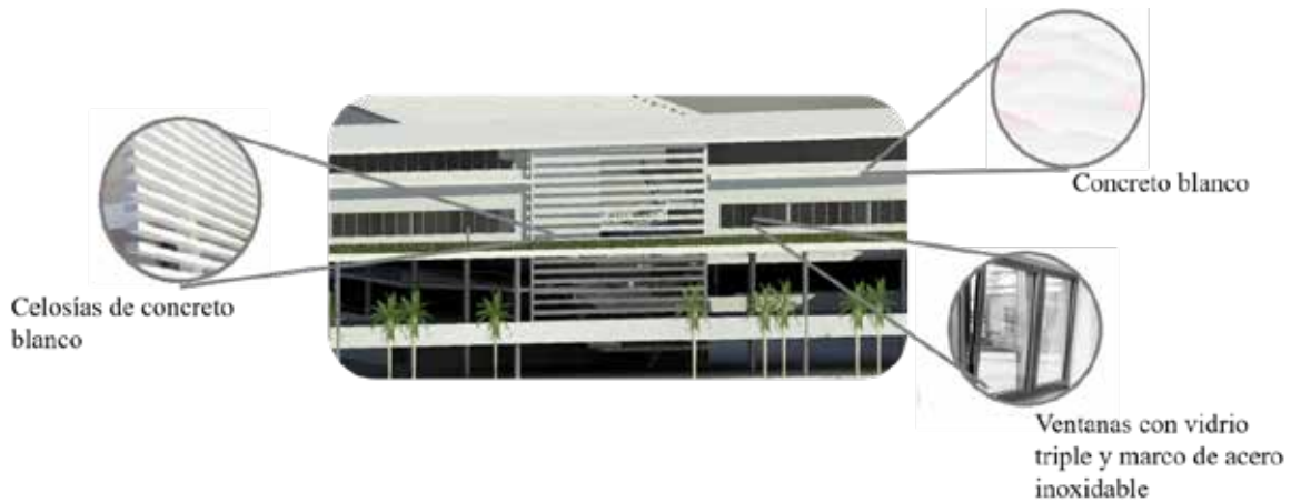
Figura 42. Materiales en modulo del complejo. (2017)
