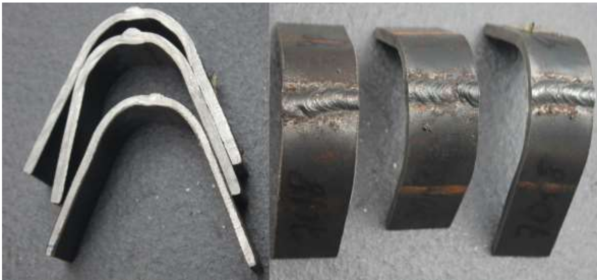
Figura 58: Doblado de la probeta soldada con E-7018 a 90A Fuente: Mercatudo J. (2017)
