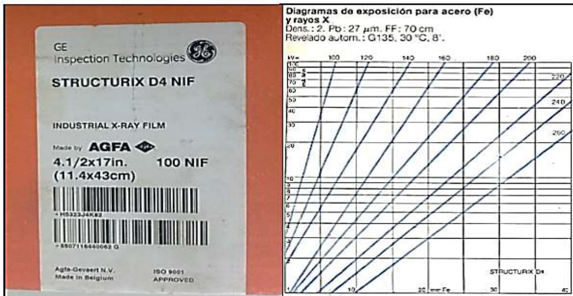
Figura 24. Película y diagrama de exposición de acero y rayos X.
