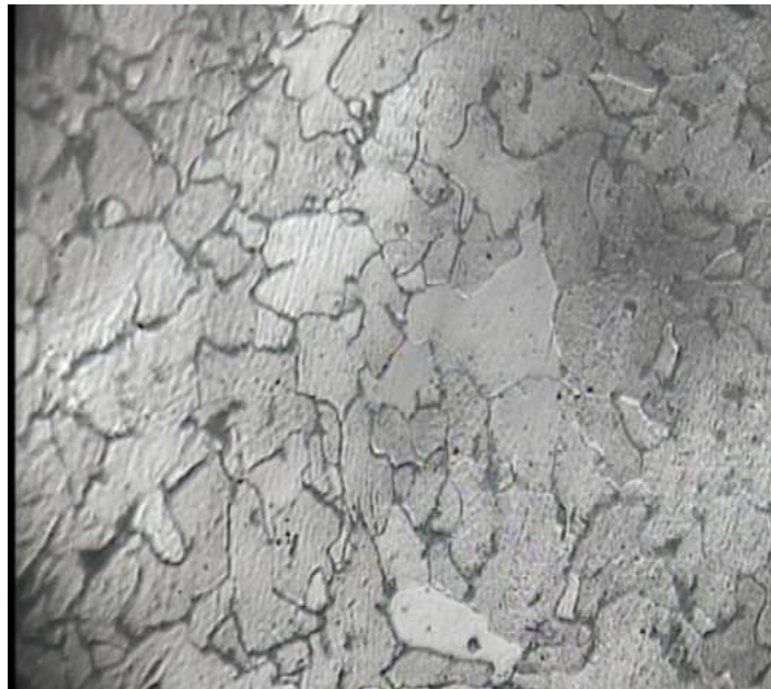
Figura 64: Microestructura del Metal Base. Acero AISI 1010 a 400X. Fuente: Mercatudo J. (2017)
