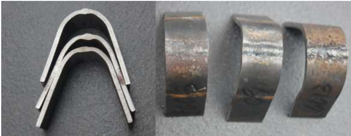
Figura 54: Doblado de la probeta soldada con E-6013 a 60A Fuente: Mercatudo J. (2017)
