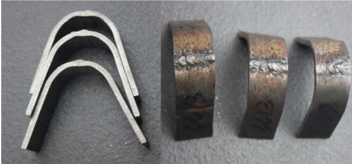
Figura 55: Doblado de la probeta soldada con E-6013 a 70A Fuente: Mercatudo J. (2017)
