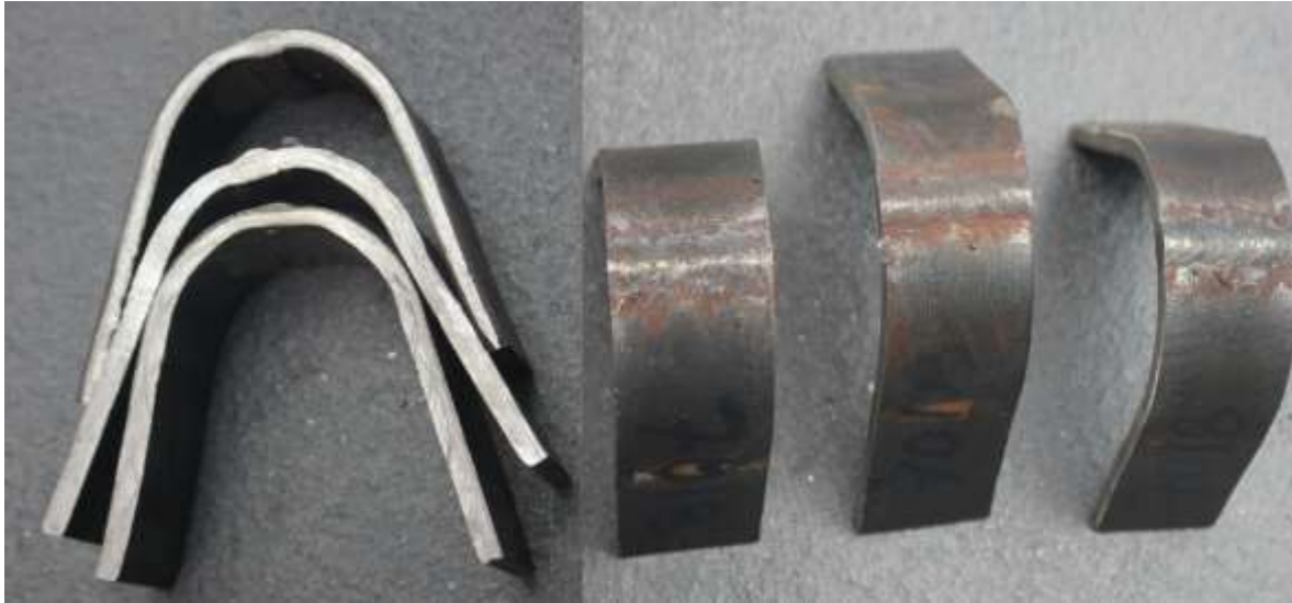
Figura 57: Doblado de la probeta soldada con E-7018 a 70A Fuente: Mercatudo J. (2017)
