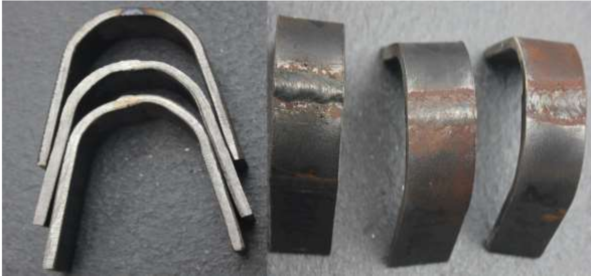
Figura 59: Doblado de la probeta soldada con E-7018 a 100A Fuente: Mercatudo J. (2017)
