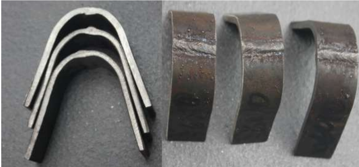
Figura 53: Doblado de la probeta soldada con E-6010 a 80A Fuente: Mercatudo J. (2017)
