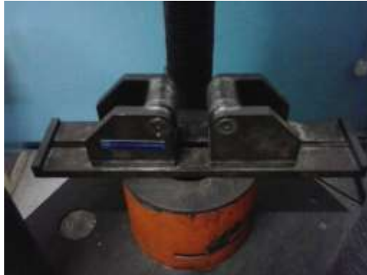
Figura 20: Dispositivo para Ensayo de Doblado.
