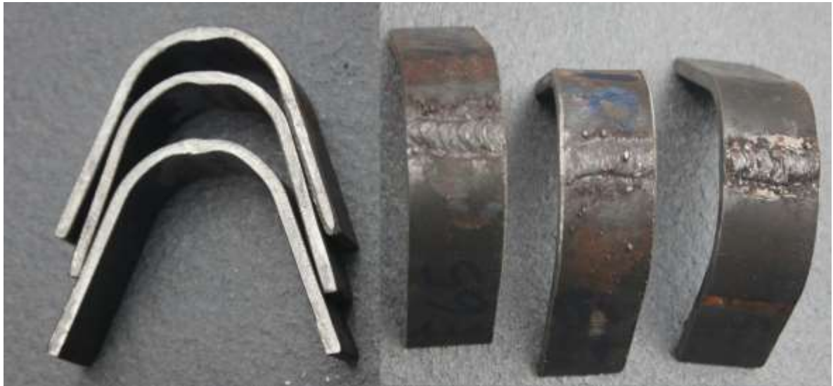
Figura 51: Doblado de la probeta soldada con E-6010 a 65A Fuente: Mercatudo J. (2017)
