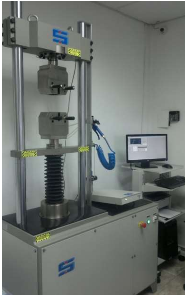
Figura 17: Máquina de ensayo de tracción marca Sistemas de Ensayos, S.L Modelo MEM-101-10-SDC Fuente: Trexa, C.A. (2017)
