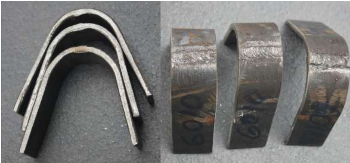
Figura 52: Doblado de la probeta soldada con E-6010 a 75A Fuente: Mercatudo J. (2017)
