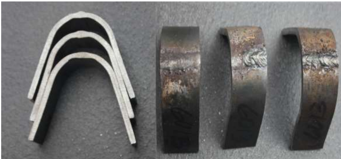
Figura 56: Doblado de la probeta soldada con E-6013 a 80A Fuente: Mercatudo J. (2017)
