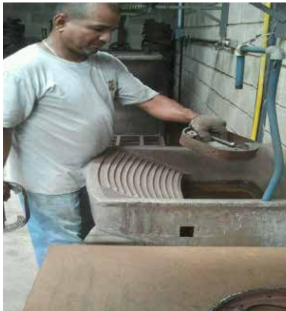
Figura 22. Enfriando los conjuntos. Fuente: BIACA, C. A.
