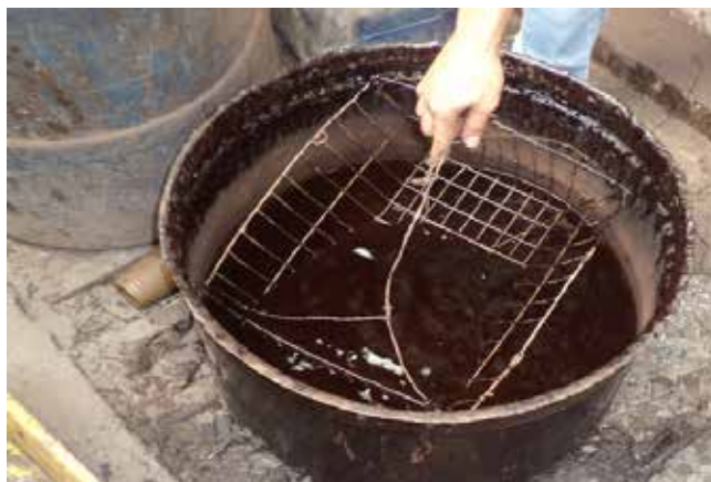
Figura 14. Barnizado Fuente: BIACA, C. A.
