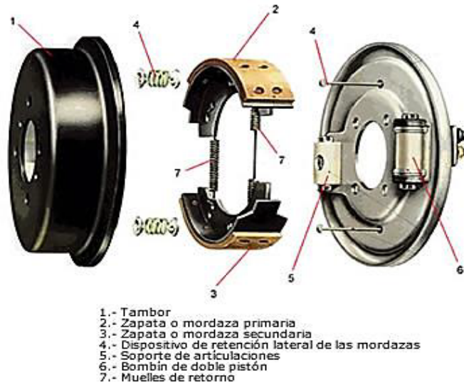
Figura 8. Elementos que forman un tambor de freno. Fuente: Mecánica virtual.
