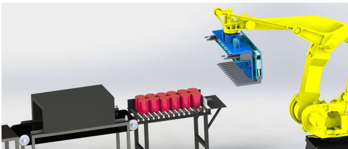
Figura 111. Distribución de la celda robótica con galones
