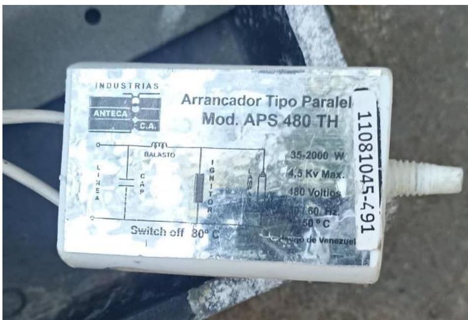
Figura 27. Características técnicas del arrancados de las luminarias y modo de conexión
