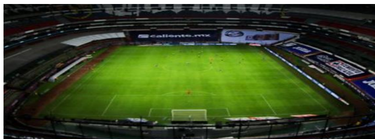
Figura 7 Iluminación deficiente con señalización en falta de uniformidad en el estadio Azteca de México
