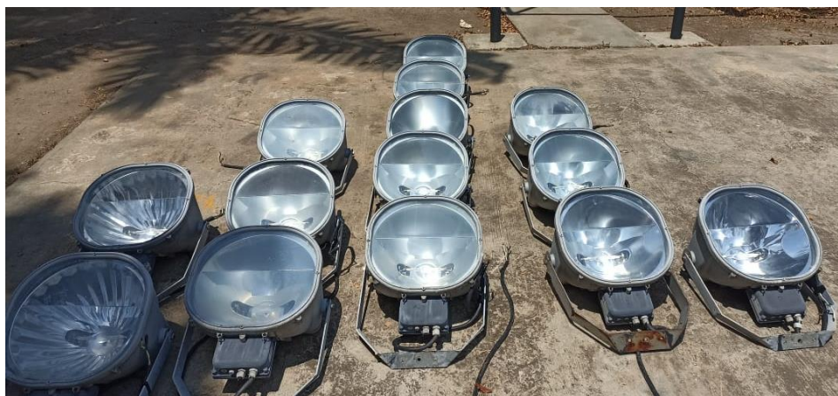
Figura 18. Organización de luminarias desmanteladas según su lente óptico
