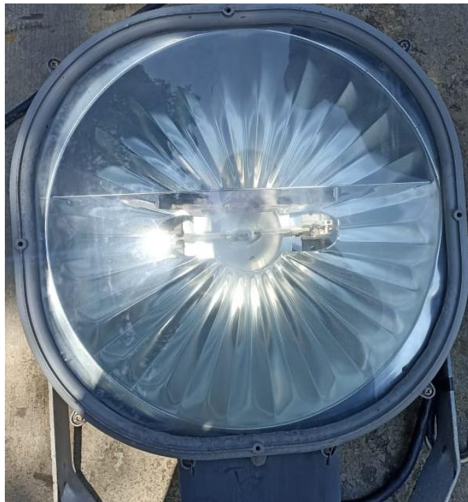
Figura 19. Luminaria desmantelada con lente óptico difundente
