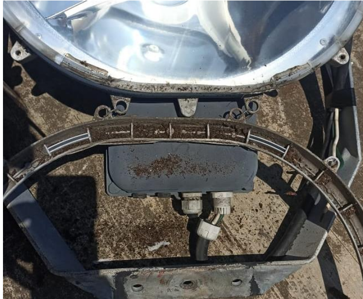
Figura 22. Suciedad presente en luminarias desmanteladas
