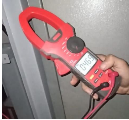
Figura 34. Resultado en multímetro de medición de voltaje
