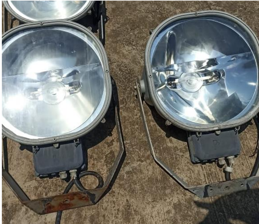
Figura 20. Luminaria desmantelada con lente óptico concentrado
