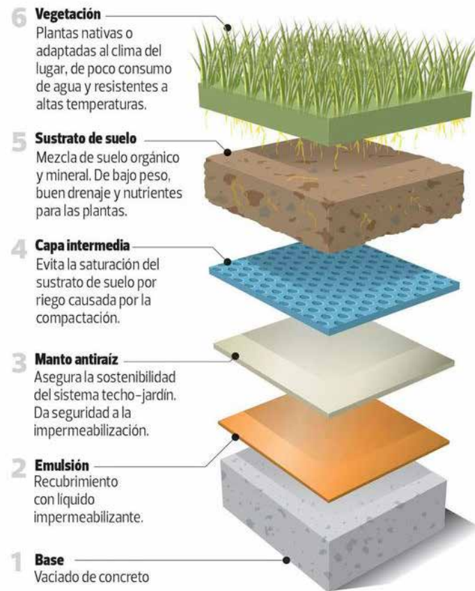
Figura 61: Revestimiento de techo verde. (2017)
