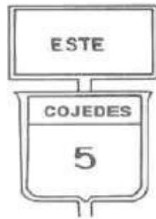
Figura 7: Señal informativa de vía troncal Fuente: Torres (2009) Manual de vías de comunicación I
