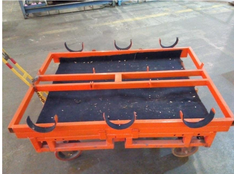
Figura 29. Racks para eje diferencial.
