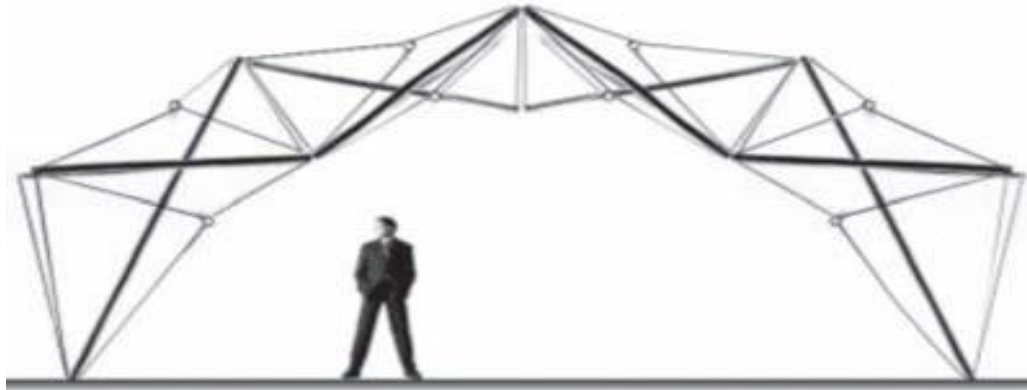
Figura 119. Forma esquemática de la malla estructural (2015) fuente: http://4.bp.blogspot.com/-s01dNefGS0U/UavRNlszk7I/AAAAAAAAAAc/fybXy-eu6E0/s1600/im2.bmp
