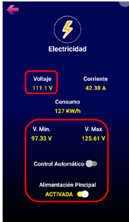
Figura 36. Pantalla electricidad de la aplicación móvil visualización voltaje y contactor
