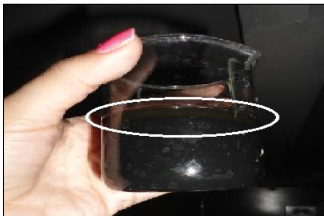
Imagen N°9: Lubricante sin Filtrar Fuente: Deivis Torrealba
