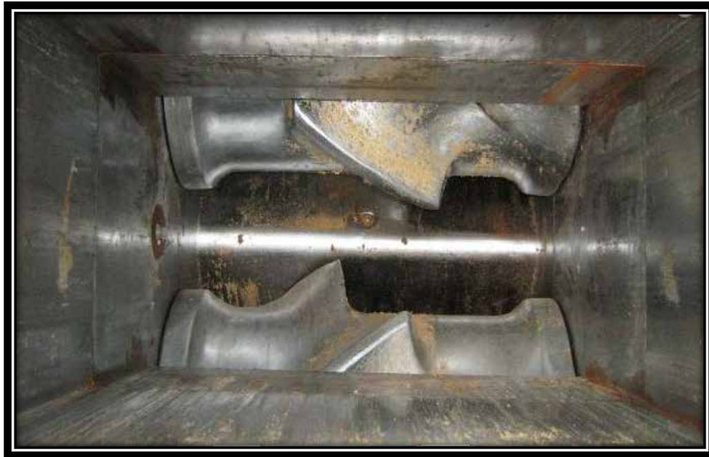
Figura N° 2 Cámara y anillos mezcladores de goma de un Banbury Fuente: Alice Neumático de Venezuela C.A
