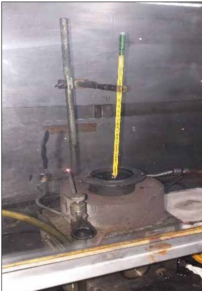
Imagen N°11: Prueba Punto de Inflamación Fuente: Deivis Torrealba
