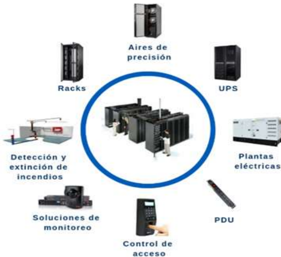
Figura 10. Infraestructura básica del data center.
