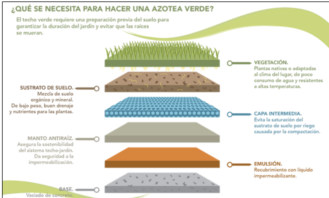
Figura 86: Estructura del techo verde. Fuente: https://perfilesalavanguardia.com/2014/03/31/que-son-las-azoteas-verdes-conocelas-e-implementalas/ (2014).
