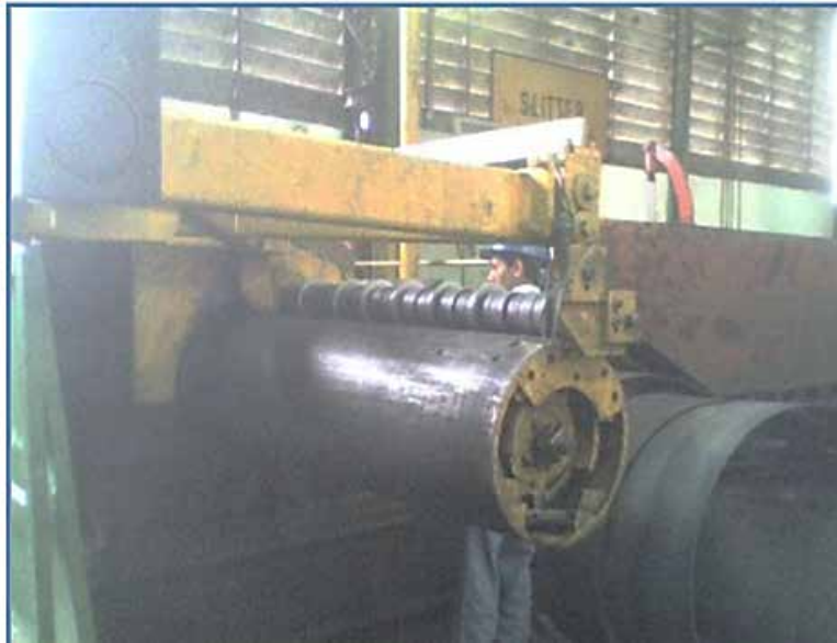
Figura 2 Zona de corte de las láminas en flejes Fuente: Propia (2019)
