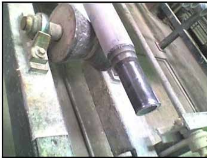
Figura 66 Rodillos usados actualmente para trasladar los tubos. Fuente: TUBOAUTO (2019)
