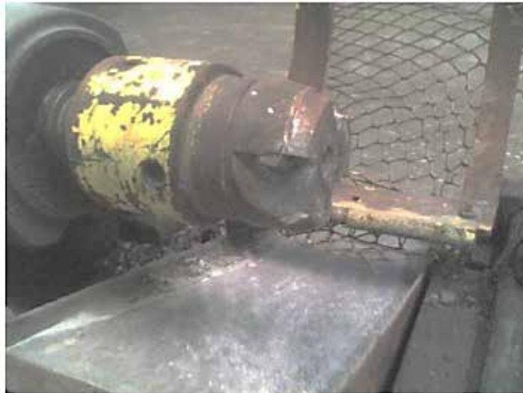
Figura 54 Mandril con insertos para realizar el biselado.
