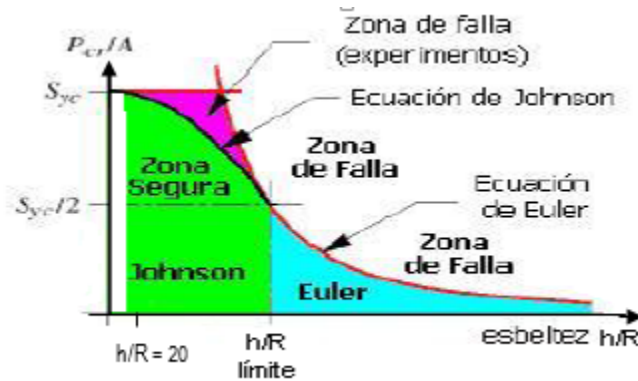
Figura 21 Representación gráfica de los criterios de Euler y de Johnson para elementos de máquina largos sometidos a cargas de compresión
