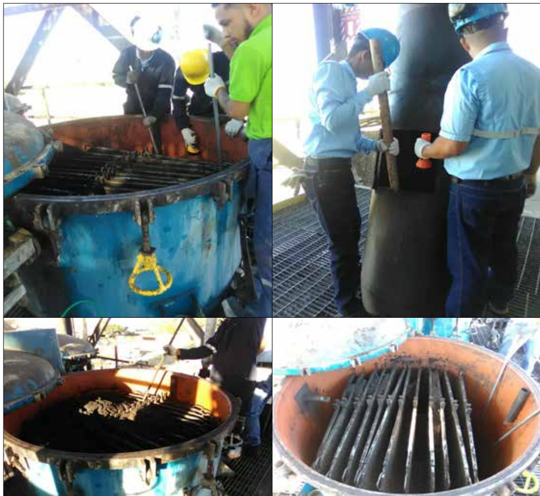
Figura 26. Baqueteo de los filtros de placas verticales. Fuente: Ruiz, J. (2020).
