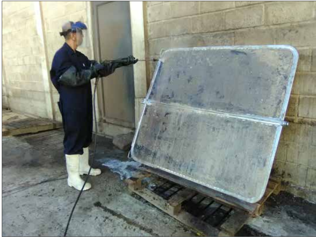
Figura 32. Lavado mecánico con Hidrojet. Fuente: Ruiz, J. (2020).
