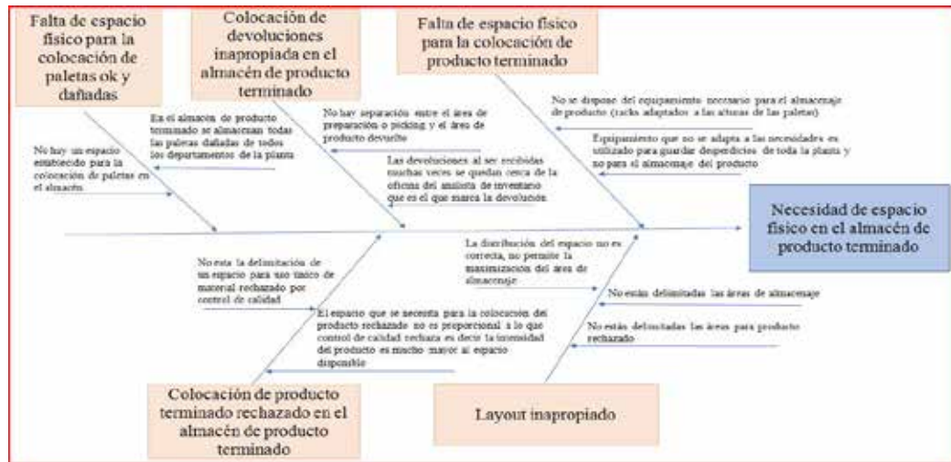
Figura 11: Diagrama Causa Efecto necesidades de espacio físico en el almacén de producto terminado
