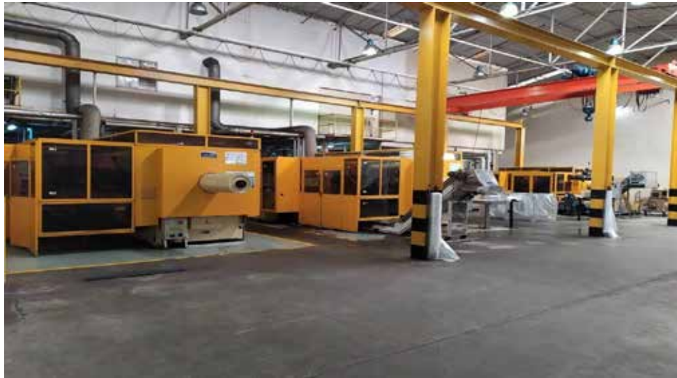
Figura N°8. Línea de moldeo por inyección de Amcor Rigid Plastics de Venezuela S.A. Autor: Rodriguez, M. (2020)
