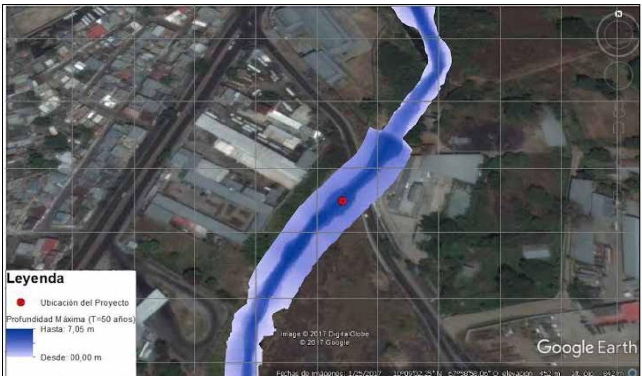
Figura 60: Mancha de inundación con fondo satelital de Google Earth ( T_r=50 ). Fuente: Guédez & Marvez, 2017
