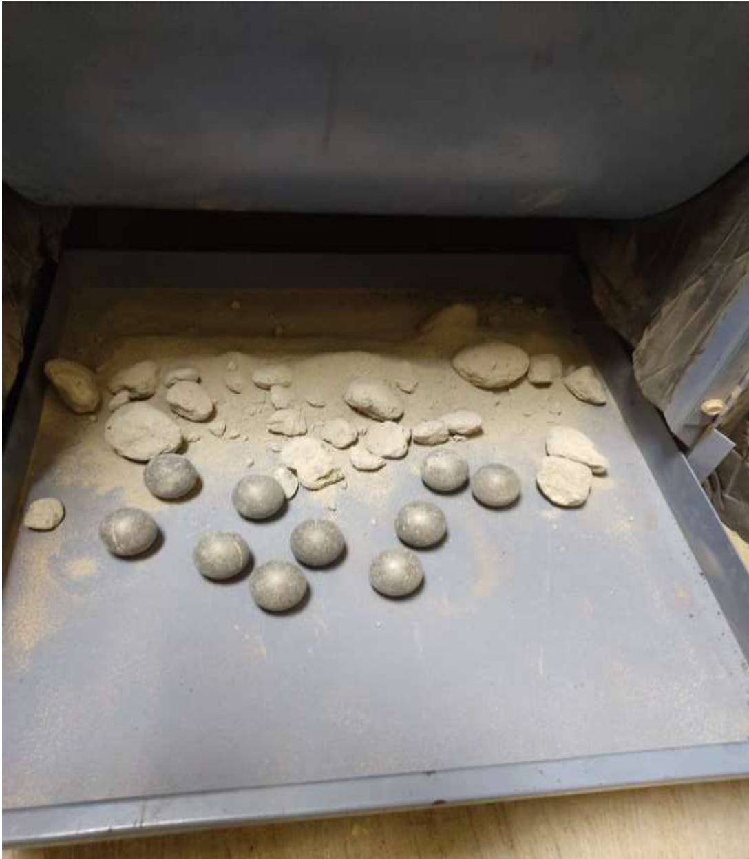
Figura 18. Vista de la muestra luego del proceso junto con esferas metálicas Fuente: Pires P. y Fonseca R. (2021)
