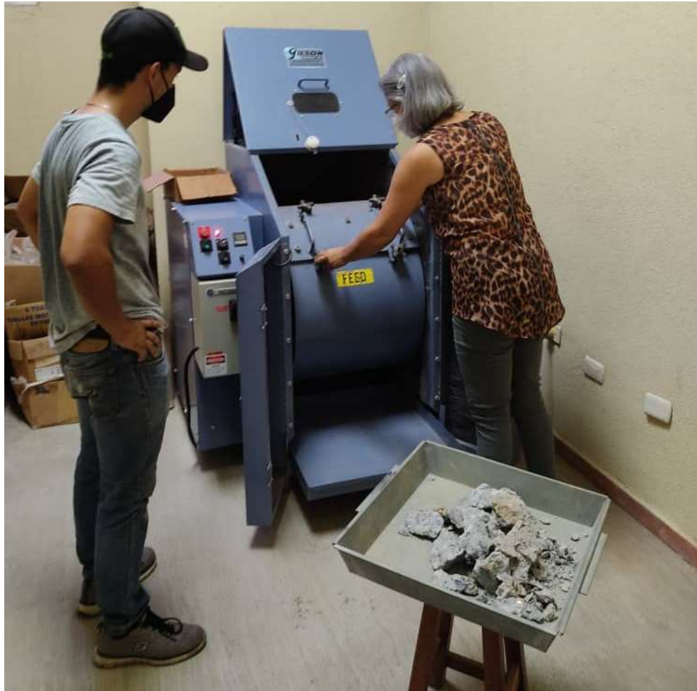
Figura 13. Preparación máquina de los Ángeles para prueba de desgaste de ambas muestras por separado Fuente: Pires P. y Fonseca R. (2021)
