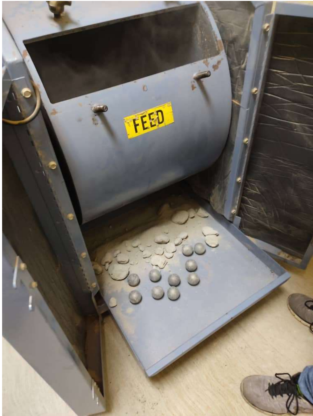
Figura 17. Vista de la muestra luego del proceso de máquina de los Ángeles Fuente: Pires P. y Fonseca R. (2021)
