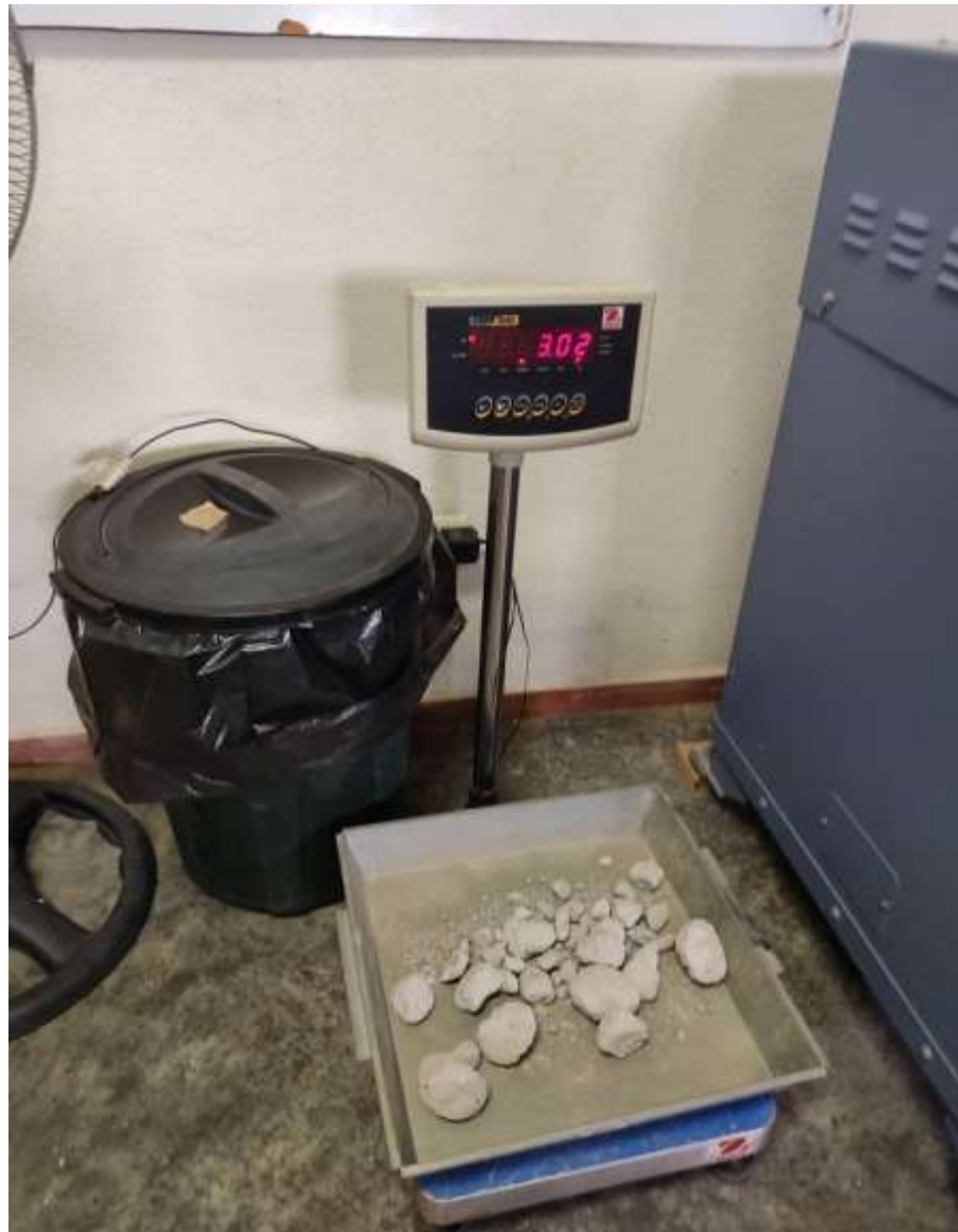
Figura 19. Peso muestras luego del proceso de desgaste de la máquina de los ángeles. Fuente: Pires P. y Fonseca R. (2021)
