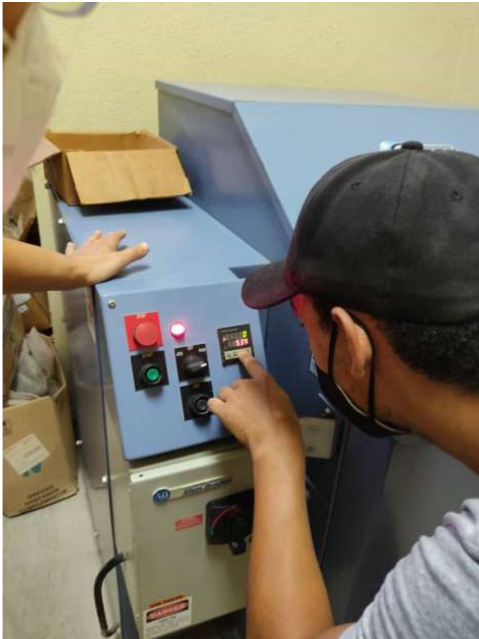
Figura 16. Ajuste de duración y revoluciones por minuto de máquina de los Ángeles Fuente: Pires P. y Fonseca R. (2021)
