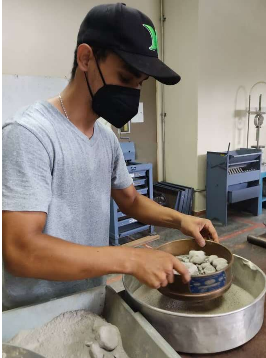
Figura 22. Pasado por tamiz N°12 MUESTRA B Fuente: Pires P. y Fonseca R. (2021)
