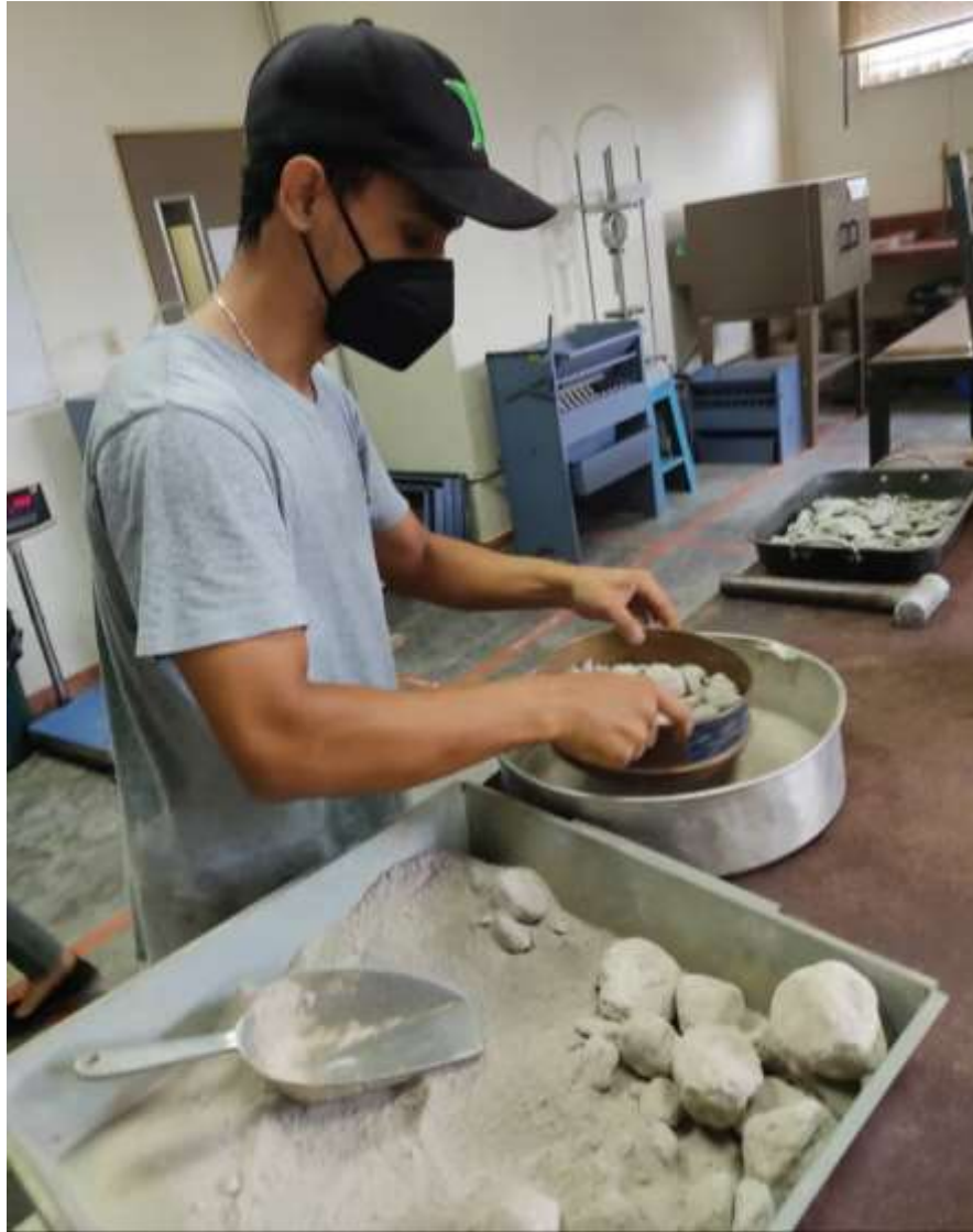
Figura 21. Pasado por tamiz N°12 MUESTRA A Fuente: Pires P. y Fonseca R. (2021)
