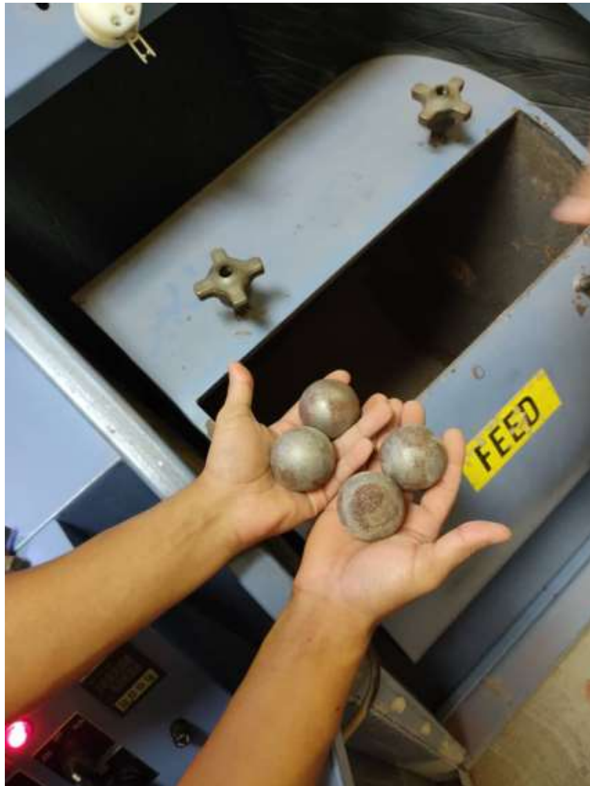
Figura 14. Esferas de acero desgastadoras y moledoras utilizadas Fuente: Pires P. y Fonseca R. (2021)
