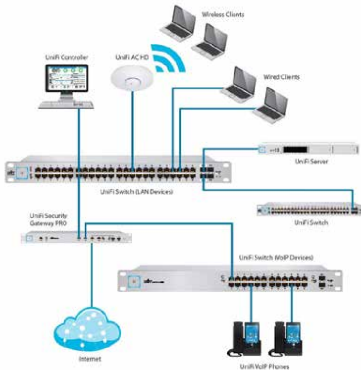
Figura 62 - Ejemplo de una red conectada a dispositivos UniFi Recuperado de UniFi PoE Switch Datasheet Página 2
