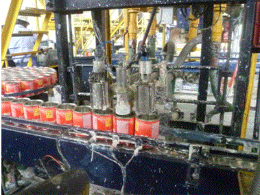
Anexo C Línea de llenado automático
