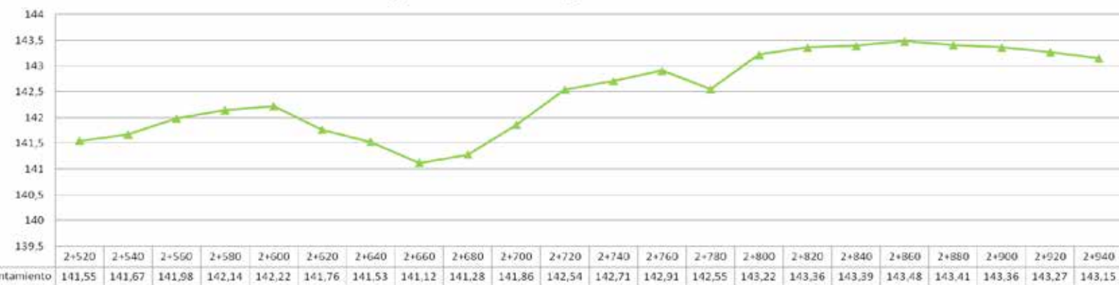
Perfil longitudinal actual. Prg. 2+520 a 2+940
