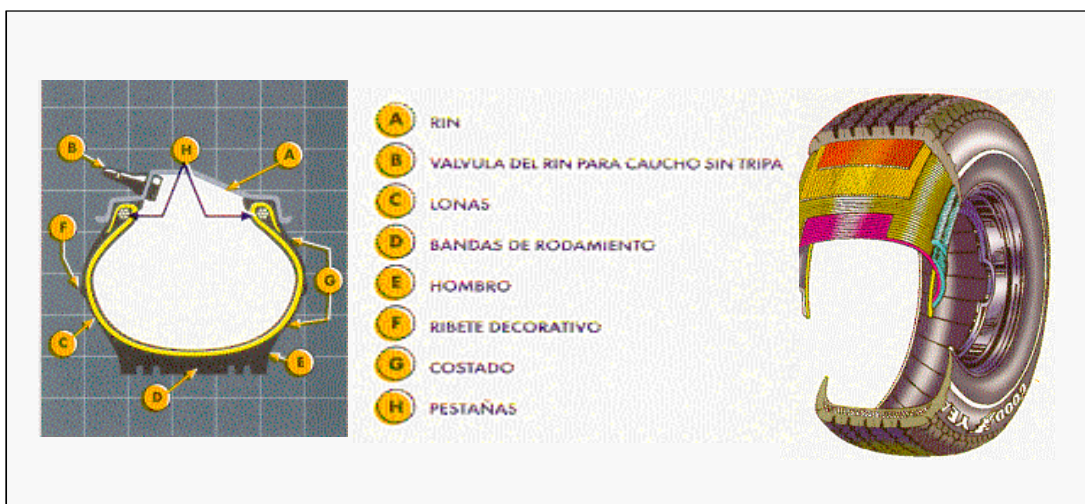
Figura 4 Corte del Neumático y sus Partes
